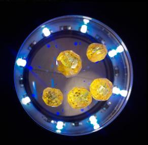
Алмазы, выращенные по технологии HPHT – химически, физически и оптически идентичные алмазам, выращенным естественным путем
